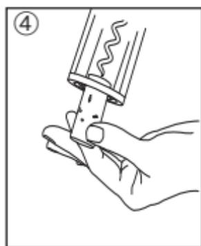
④ Pour retirer le bouchon du tire-bouchon, maintenez la partie supérieure du bouton de démarrage enfoncée.
