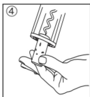
④ Om de kurk uit de kurkentrekker te draaien, houdt u het bovenste deel van de startknop ingedrukt.
