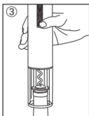
③ Halten Sie den unteren Teil des Startknopfes gedrückt, üben Sie zeitgleich etwas Druck nach unten aus. Die Spirale dreht sich in den Korken und zieht diesen heraus. Sobald der Korken vollständig aus der Flasche gezogen wurde, stoppt der Korkenzieher automatisch. Lassen Sie den Startknopf los und nehmen Sie den Korkenzieher von der Flasche.
