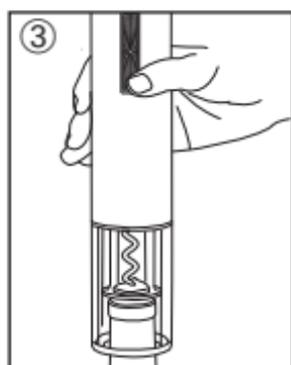
③ Houd het onderste deel van de startknop ingedrukt en oefen tegelijkertijd een beetje neerwaartse druk uit. De spiraal draait in de kurk en trekt deze uit. Zodra de kurk volledig uit de fles is getrokken, stopt de kurkentrekker automatisch. Laat de startknop los en haal de kurkentrekker van de fles.
