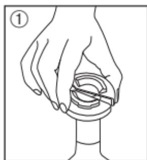
① Détachez le coupe-capsule du tire-bouchon et placez-le à l'horizontale sur le goulot de la bouteille. Comprimez-le légèrement d'une main de manière que les lames soient en contact avec la capsule. Saisissez la bouteille avec l'autre main et coupez le film plastique.
