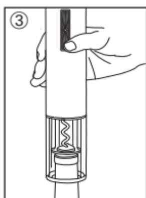
③ Maintenez la partie inférieure du bouton de démarrage enfoncée et exercez simultanément une légère pression vers le bas. La spirale tourne dans le bouchon et le retire. Dès que le bouchon est complètement sorti de la bouteille, le tire-bouchon s'arrête automatiquement. Relâchez le bouton de démarrage et retirez le tire-bouchon de la bouteille.
